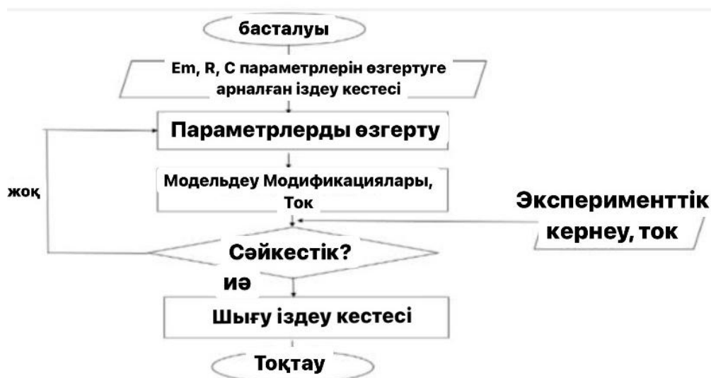
2.12 Сурет - Эквивалентті схема элементтерінде Имитациялық параметрлерді алуға арналған технологиялық схема
